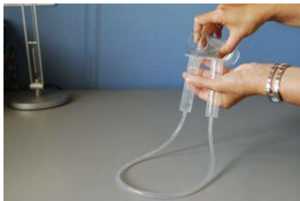
Foto 47. Jeringas unidas a través de un tubo.
