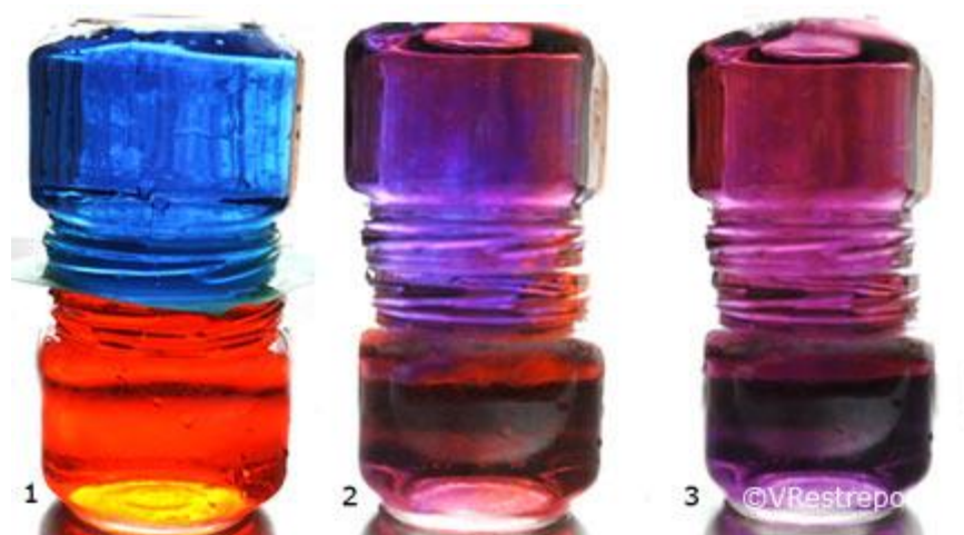
Foto 52. Proceso inverso, el frasco con agua fría se encuentra arriba y el frasco con agua caliente abajo. Observe como se mezclan las aguas.
