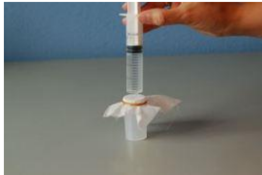
Foto 56. Colocación del agua sobre el recipiente tapado con la tela
